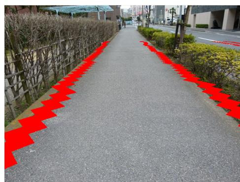
(d) 二乗損失相互情報量推定量の最大化によって推定した自己位置に基づいて、道路境界をカメラ画像に投影した結果
